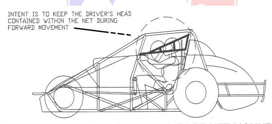
RECOMMENDED / PROPER ROLL CAGE NET MOUNTING
